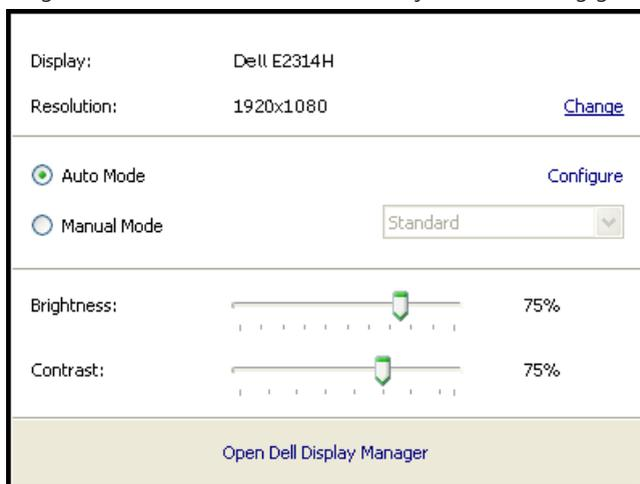
Der Schnelleinstellungsdialog bietet zudem Zugriff auf die erweiterte Benutzeroberfläche des Dell Display Managers, die der Anpassung von Basisfunktionen, der Konfiguration des Auto-Modus und dem Zugriff auf weitere Funktionen dient.
